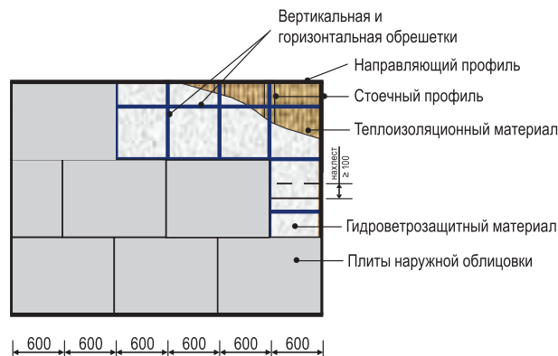
Рис. 22. Крепление наружной облицовки к каркасу
