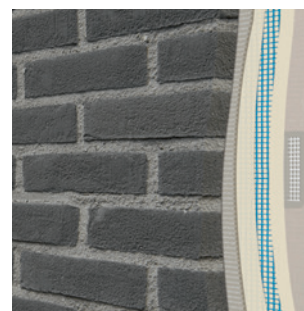
Рис. 27. Облицовка плиточным материалом наружной обшивки
